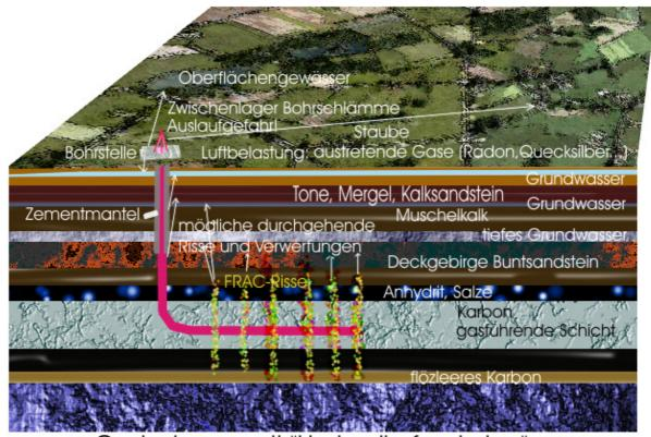
Gasbohrung mit "Hydraulic fracturing"
